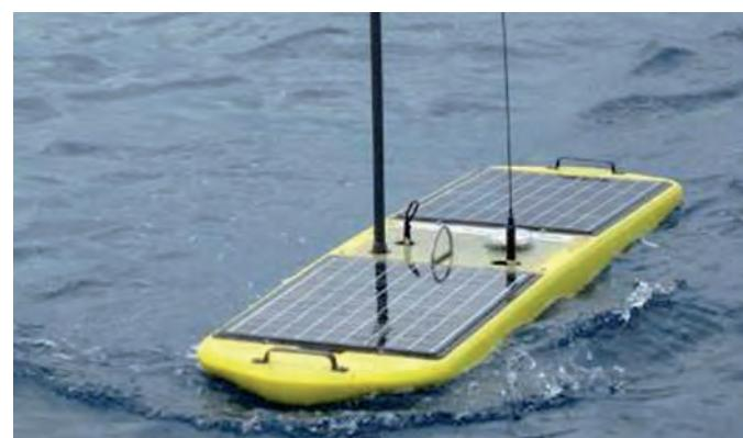
ta. Prema Luovim riječima, senzori ugrađeni u ovo robotsko plovilo mogu pratiti onečišćenja, izljevanje nafte, stupanj saliniteta mora, pa čak i aktivnosti fitoplanktona.
