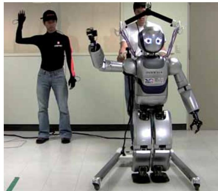
Robot može učiti na dva načina, sa snimki pokreta, ili koristeći posebne senzore pričvršćene na tijelo osobe koju imitira. Jednog dana će ovakvi roboti moći obavljati jednostavne zadatke koji zahtijevaju manipulaciju predmetima i rukovati se s ljudima.
